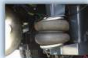
Sollevatore sul primo asse
